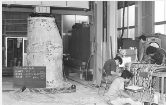
写真 - 1 外圧試験機による強度確認テストの様子
