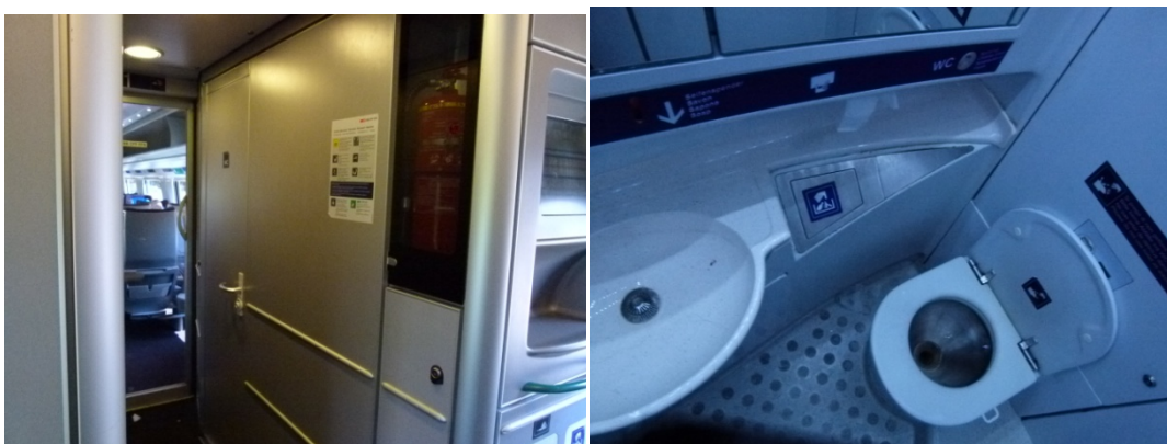
写真1 3 スイスの EC の特急車両のトイレの出入り口と真空式トイレと手洗い 2013.7.6 亀田泰武氏提供
