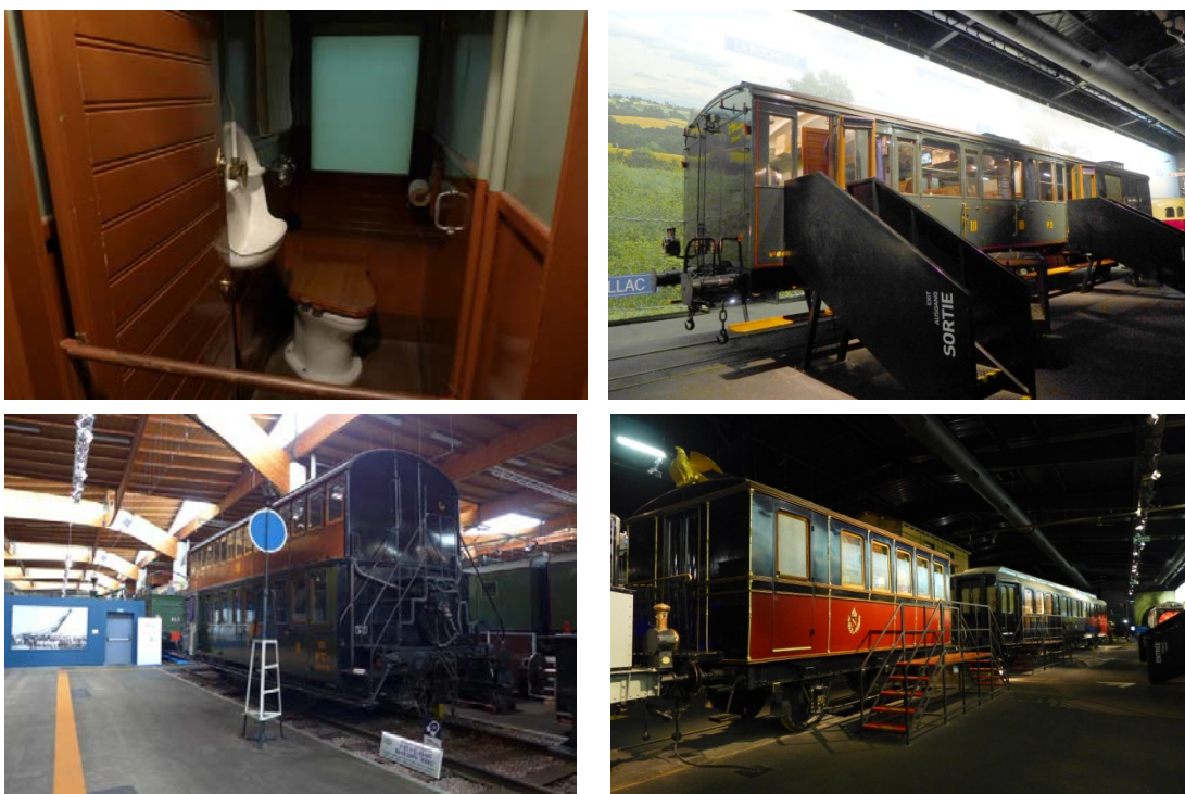
写真6 1910年の車両と列車トイレ。博物館内の車両で見つけた汚物垂れ流し管、当時はパイプではなく箱型のようなです。 2013.7.4 亀田泰武氏提供
