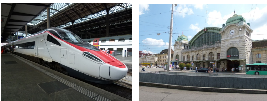
写真1 2 バーゼル駅に到着したスイスの EC 特急列車とバーゼル駅舎。この EC 特急はイタリアと共同開発した車両で、ETR600 フレッチャ・アルジェント（動力分散型）と同じ型をしています。 2013.7.6 亀田泰武氏提供
