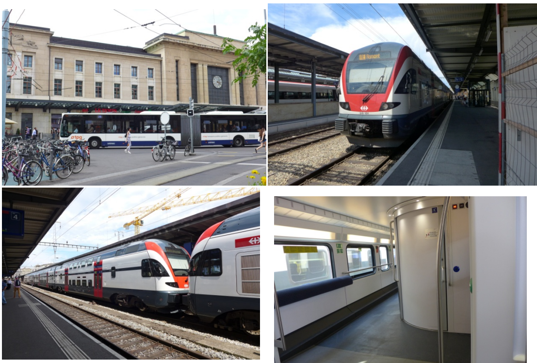
写真1 ジュネーブ駅舎と構内に停車中の2階建て電車とそのトイレの出入り口。車両は2階建てで水洗トイレの汚物は貯留されていると思われます。汚物流し管は見つかりません。 2013.7.2 亀田泰武氏提供
