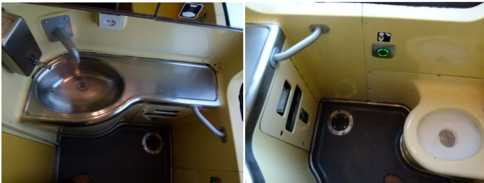
写真15 同列車の水洗式汚物垂れ流しトイレと洗面器 2013.7.6 亀田泰武氏提供
