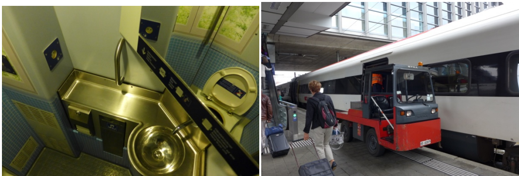
写真2 ジュネーブ駅始発バーゼル駅行きの ICN621 列車。トイレの壁には、車窓からの 景色に見立てた絵と花の絵が描かれています。便器には水が溜まっているので水洗 式のトイレで、汚物はタンク貯留と思われます。 2013.7.3 亀田泰武氏提供
