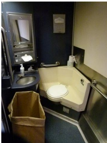
写真5 コースト・スターライト号の車椅子対応の真空式トイレ 2013.5.26 京都大学鉄道研究会 OB 路次安憲氏提供
