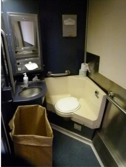
写真5 コースト・スターライト号の車椅子対応の真空式トイレ 2013.5.26
