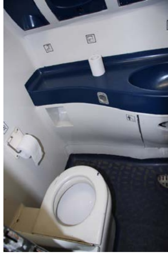
写真8 我々がリオマンガオレ駅からラ・スペツツィア駅まで乗車した Le642 車両の垂れ流しの水洗トイレ 2014.3.8
