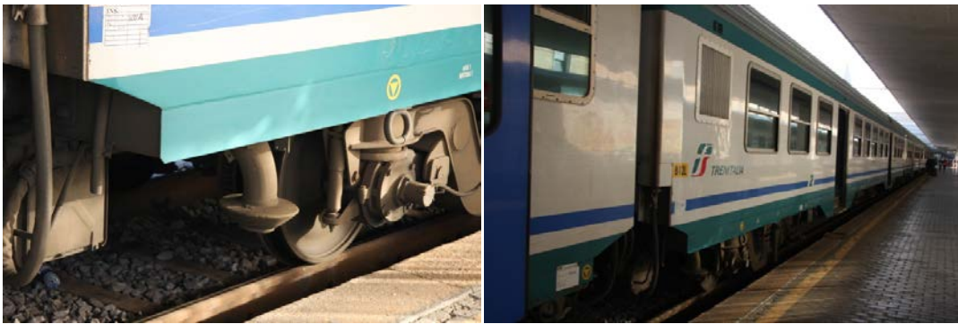
写真1 2 フィレンツェ駅での VC/VE 型中・近距離区間の車両と汚物垂れ流し管
