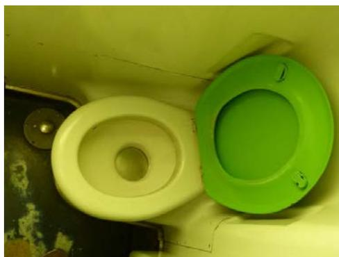
写真5 急行インターシティーの列車トイレ。日本の簡易水洗トイレのように汚物流し口に蓋がついているので汚物はタンクに蓄えていると思われます 2012.6.4 路次安憲氏提供
