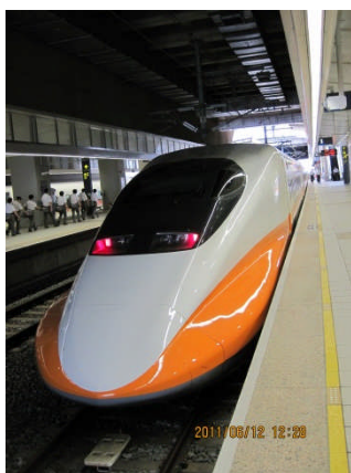
写真—1 台湾高速鉄道終点高雄左営駅で発車を待つ高速鉄道用700T系車両。日本の東海・西日本新幹線700系をベースに台湾用に川崎重工が製造しました。
