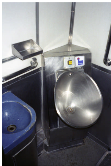
写真一13 台湾の気動車特急自強号の列車トイレ、男子用と男女共用和式トイレ。水洗用のノズルが見えますので真空式トイレと思います。車両は 1998 年の日車製です。 2010.12.11 真鍋祐司氏提供
