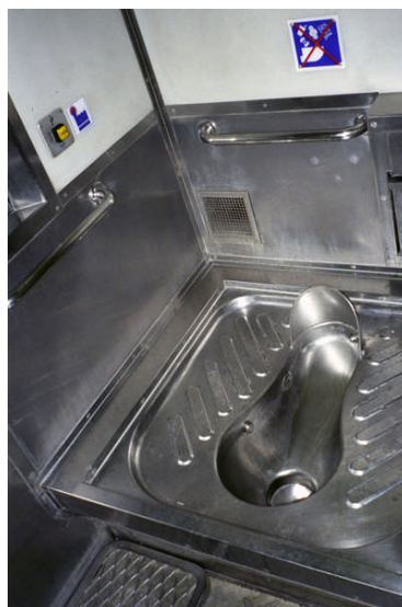
写真一13 台湾の気動車特急自強号の列車トイレ、男子用と男女共用和式トイレ。水洗用のノズルが見えますので真空式トイレと思います。車両は 1998 年の日車製です。 2010.12.11 真鍋祐司氏提供
