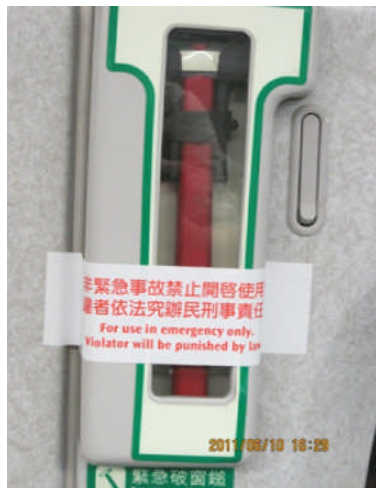
写真—6 日本の新幹線車両には見られない緊急脱出用のハンマー、この赤いハンマーを取り出しドアのガラスを破り脱出するようです。 2012.6.12 重宗勝人氏提供
