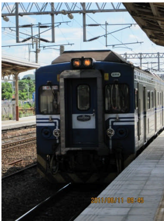
写真一11 左営駅から高雄駅に連絡する電車。韓国製でトイレは装備されていません。
