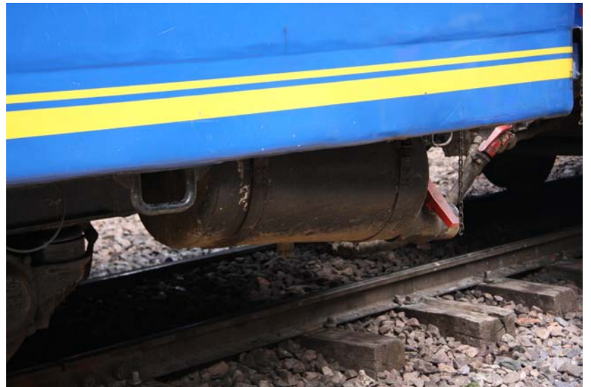
写真7 トイレトペーパーも装備されていました。また列車を降りてトイレの下を覗くと円筒形の小さな汚物を貯めるタンクがありました。 2013.4.4
