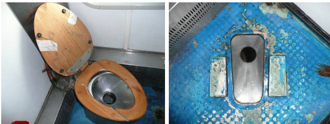
写真4 トイレは車両の両端にあり片方が洋式トイレ、反対側にしゃがみ式トイレがついています。トイレは水洗式ですが汚物は垂れ流しです。
