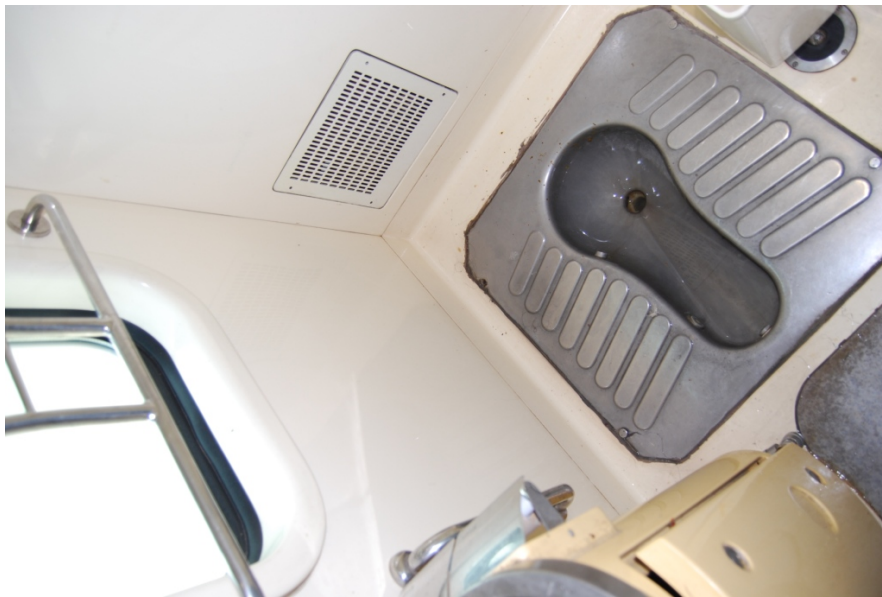
写真10 チベット鉄道の真空式トイレ（汚物を流すための小さなノズルがついています）
