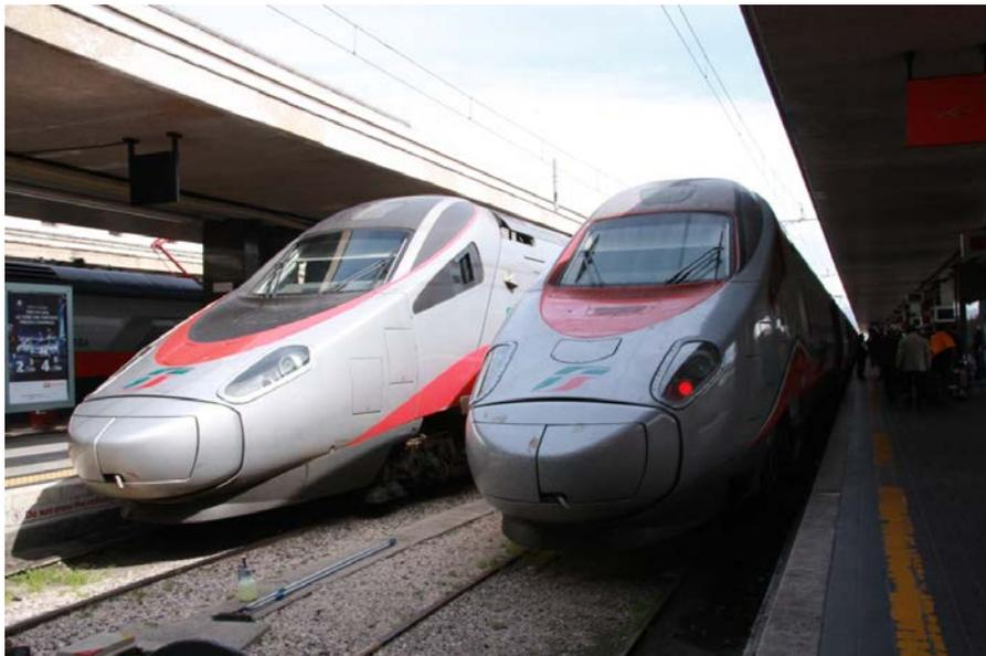
写真3 我々がローマからボローニャまで乗車した高速列車（アルタ・ヴェロチタ・ファスト）フレッチャ・アルジェント（銀の矢）ETR600 の動力分散型の新型車両です。ボローニャ駅にて 2012.4.24
