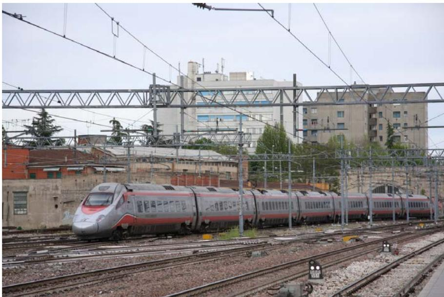
写真5 2008年から営業を開始した ETR600 のフレッチャ・アルジェント（銀の矢）は日本の新幹線と同じ動力分散方式の電車で、第3世代の振り子式車両です。1等車2両、2等車5両の7両編成で座席数を増やしたビジネス用の高速電車で、最高営業速度は250km/hです。 ボローニャ中央駅 2012.4.25
