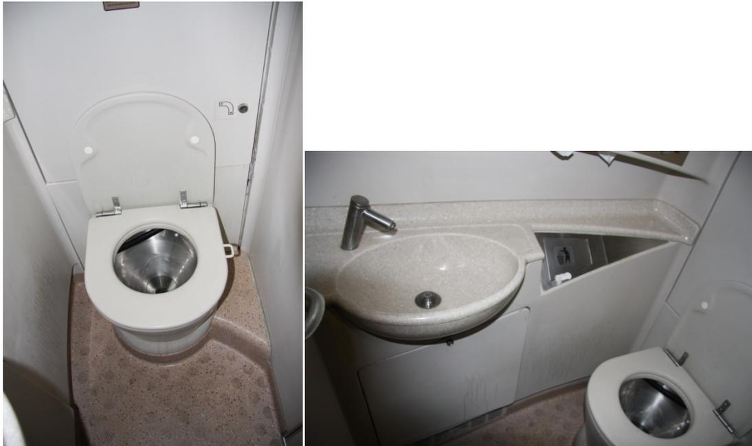
写真4 我々が乗車したフレッチャ・アルジェントの真空式トイレと手洗い
