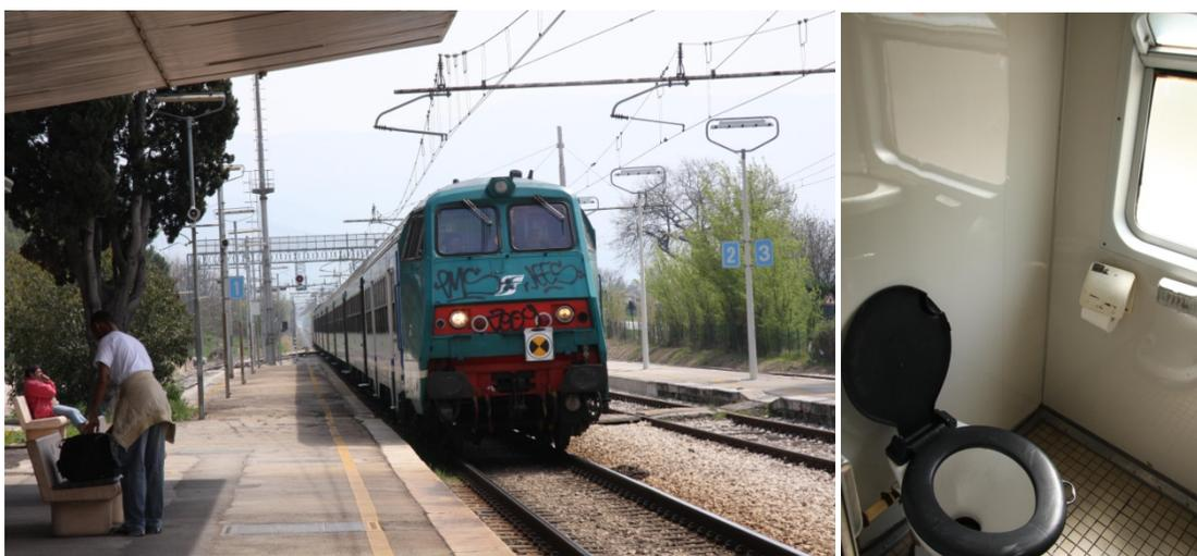
写真17 スペッコ駅からフィレンツェ駅まで乗車したIC急行 (MDVC/MDVE型) とその垂れ流し式トイレ
