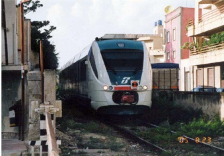
写真 2 4 新型のメヌエット、地方の老朽車両の置き換えに 2004 年からアムストム社により製造された地方面向けの近郊車両で電車と気動車の 2 タイプがあります。シチリア エリチンエ駅に到着した気動車タイプ、もちろんトイレは常備されていますが垂れ流しでしょう。地上設備が間に合わないと思います。 2005.8.23
