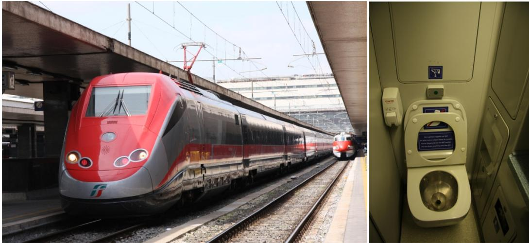
写真6 イタリア高速列車を代表するフレッチャ・ロッサ（赤い矢）の ETR500 と真空式トイレ。両端電気機関車方式のプッシュプルで振り子方式ではないが最高営業運転は 300km/h です。プレミアムシートとエクシブルシートを設けた 1 等車 4 両と 2 等車 6 両に食堂車を加えた 11 両編成です。
