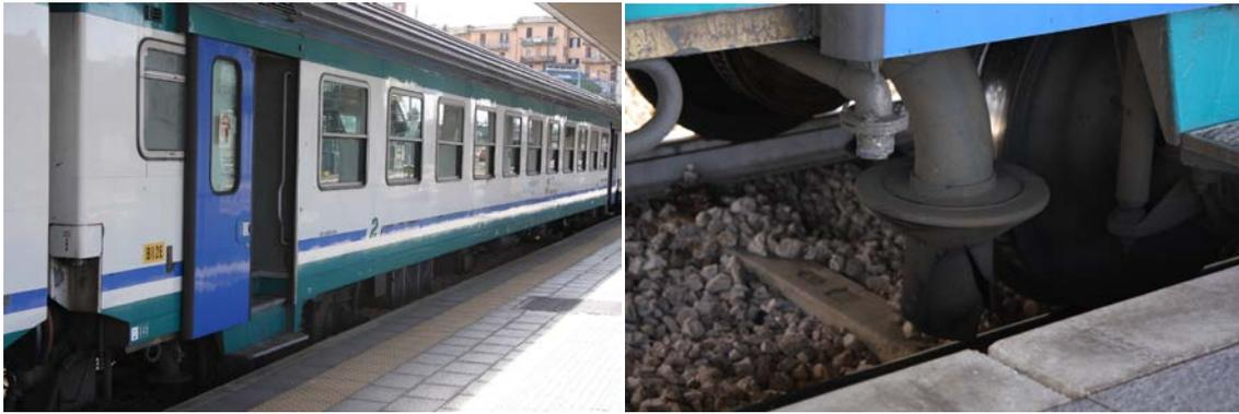
写真14 ミラノ中央駅からスイス・スピッツまで乗車したイタリアの EC、水洗式トイレですが汚物は垂れ流しです。私が乗車したときはスイスの国境の町ドモドッソラ駅で機関車はスイスの機関車と交代しました。 ミラノ中央駅にて 2004.8.21
