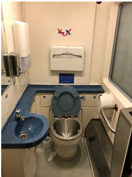
写真 5 アエロエクスプレスの真空式トイレ 2018.11.19
