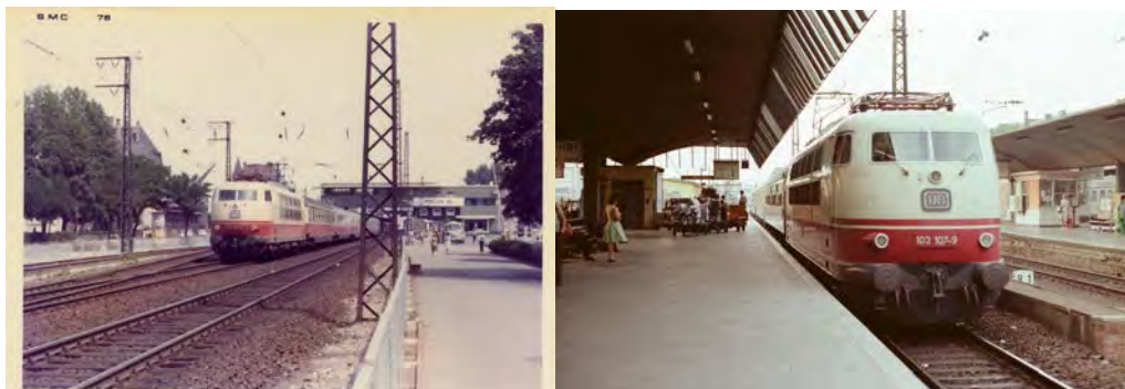
写真1 ドイツ主要都市を結ぶ高速列車 (TEE)。当時は最新の103交流電気機関車(最高速度200km/h)の牽引だが、車両のトイレは全て垂れ流し。トイレからレールを見るのができた。左がビンゲン駅を 통과する IEC、右がコブレッツ駅で我々が乗車した IEC
