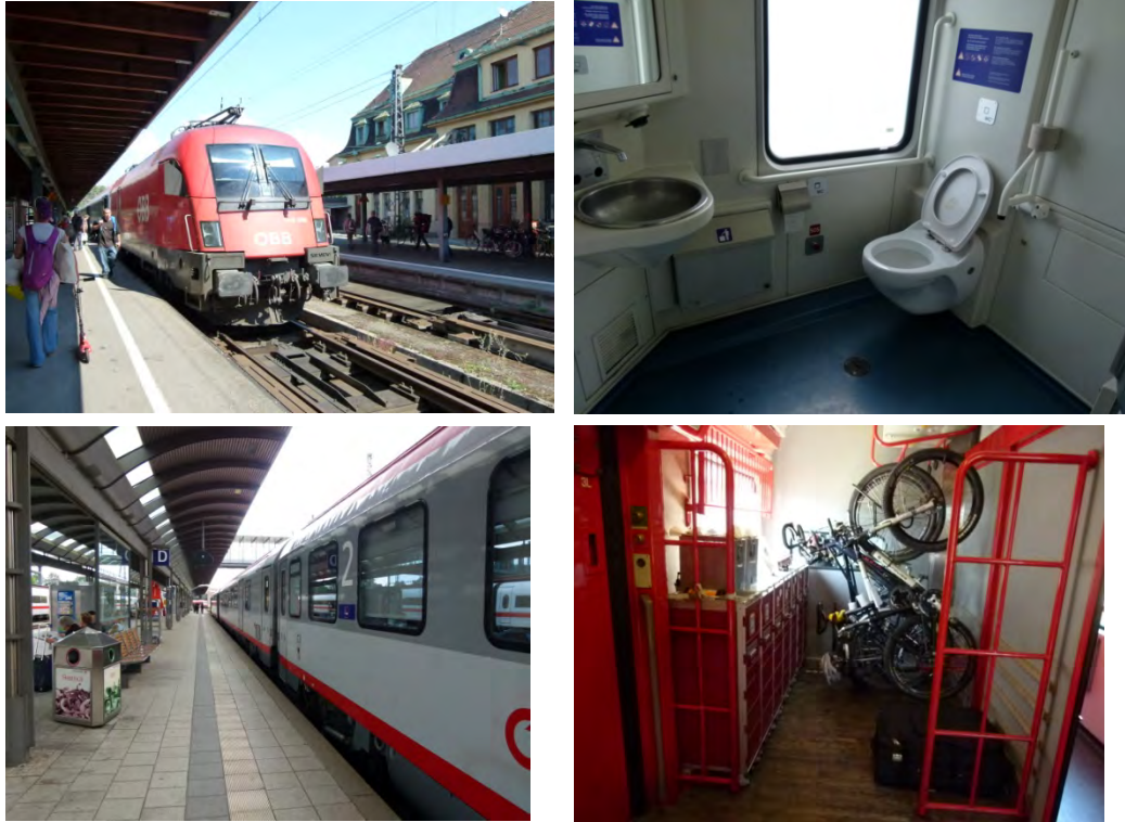
写真12 リンダウーウルム IC118 オーストリアの列車トイレ、オーストリアの機関車が牽引している。オーストリアの車両でトイレも普通の水洗式で汚物は貯留していると思われる 2012.8.10 亀田泰武氏提供
