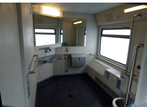
写真8 101型交流電気機関車の牽引による DB レギオの2階建て列車、ヴェルツブルグーバンベルグのトイレは障害者も使用できる広い真空式です
