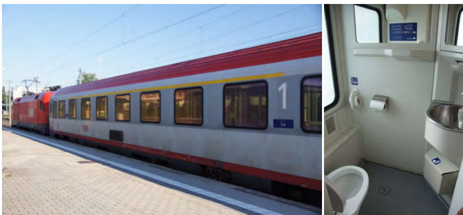
写真13 EC113 の1等車両 ローカル線でも列車トイレは水洗で汚物はタンクに貯留しているようです。この列車もオーストリアの車両です 2012.8,13 亀田泰武氏提供
