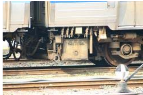
写真 22b. N2000の循環式タンク 06.9.30
