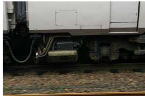
写真 23b. 183系の循環式タンク 06.10.7
