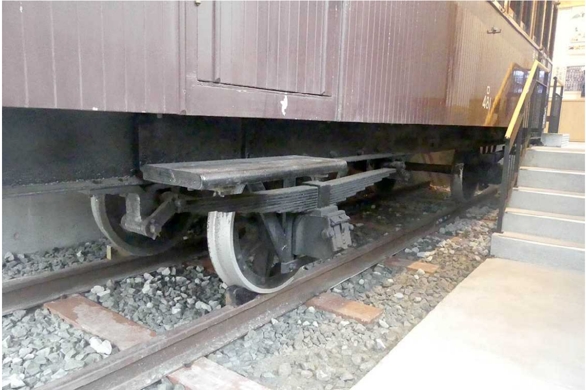
写真5、口481号車両の一軸台車の板バネ
