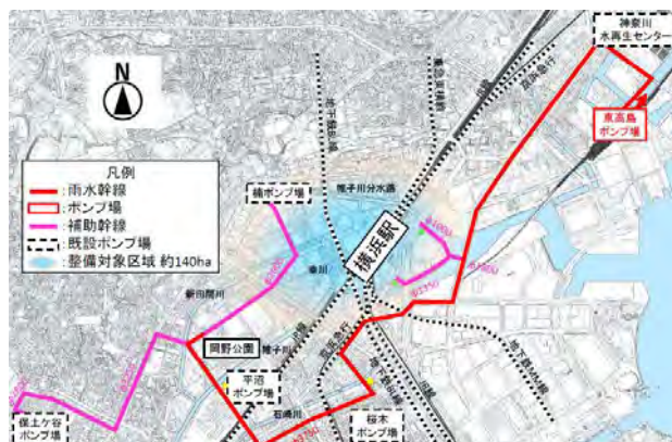
図-2 エキサイトよこはま 竜宮橋雨水幹線・東高島ポンプ場
