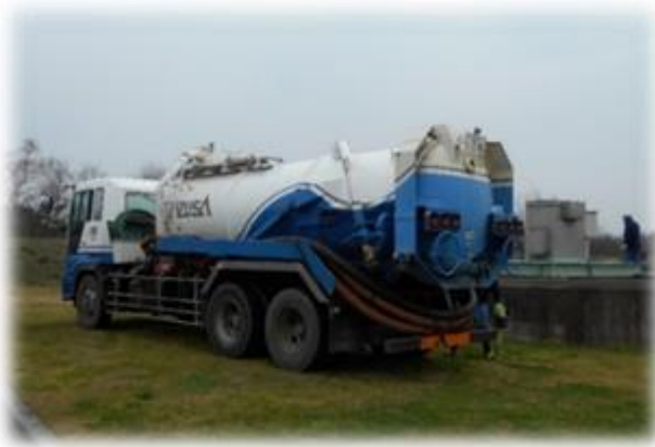
写真4 波田浄化センターからの汚泥受け入れ用特殊車両
