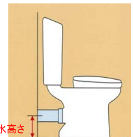
昔の床上排水型便器は排水高さ155~170mmが多く、それに合わせて立て管を作ってしまった (有)マンションライフパートナーズ 27
