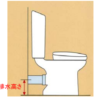
昔の床上排水型便器は排水高さ155~170mmが多く、それに合わせて立て管を作ってしまった (有)マンションライフパートナーズ 26
