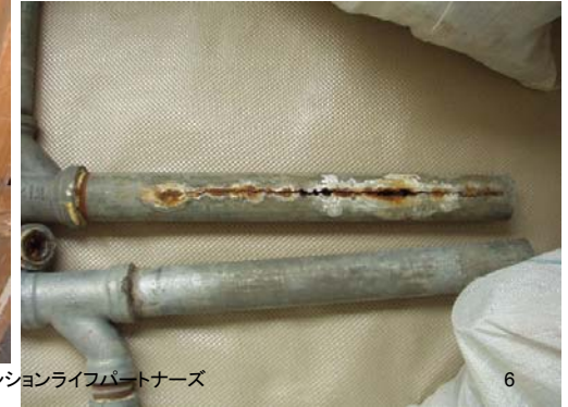
電縫部の溝状腐食例
