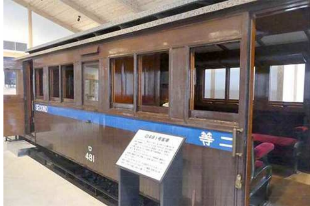
右写真 トイレ付き4輪の木造客車 中央部分がトイレ室 ⇒
