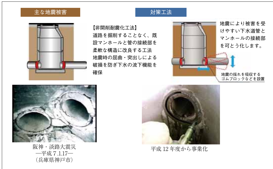
図-4 下水道管きよの主な地震被害と対策工法
