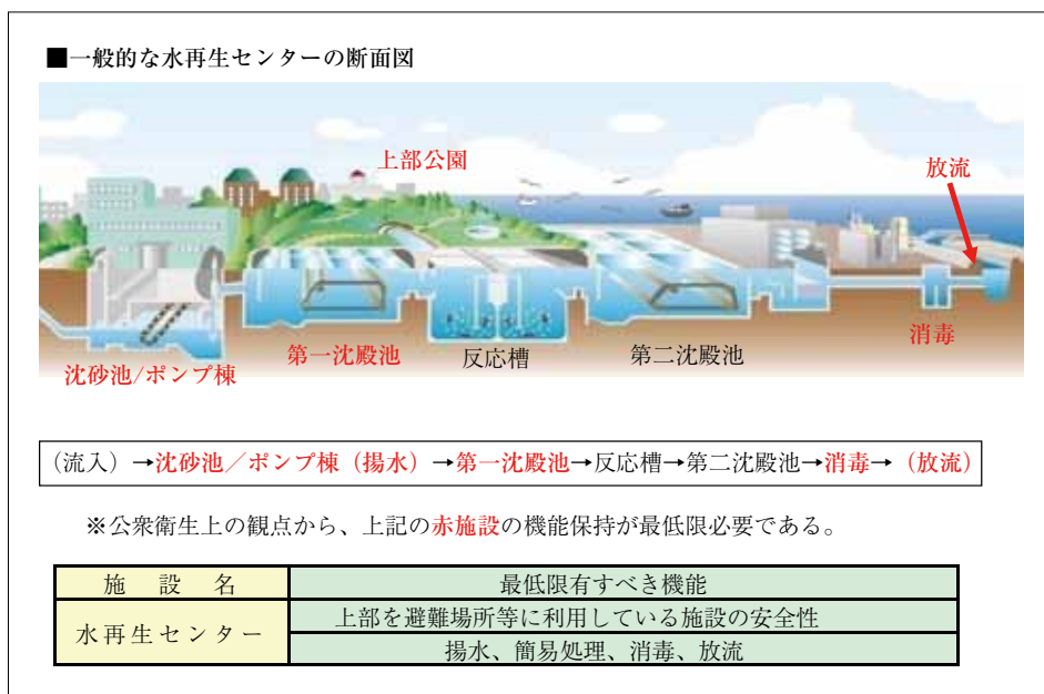
図-2 水再生センター（被災時にも最低限有すべき施設）の耐震基準
