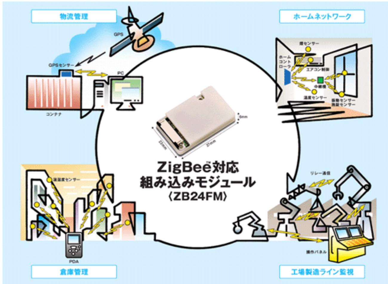
ZigBee : 省電力な低速無線通信技術であり、プロトコルを単純化し機能を限定することによってデータサイズを抑え、低コストでのネットワーク構築を可能とした次世代無線ネットワークの国際規格プロトコル
